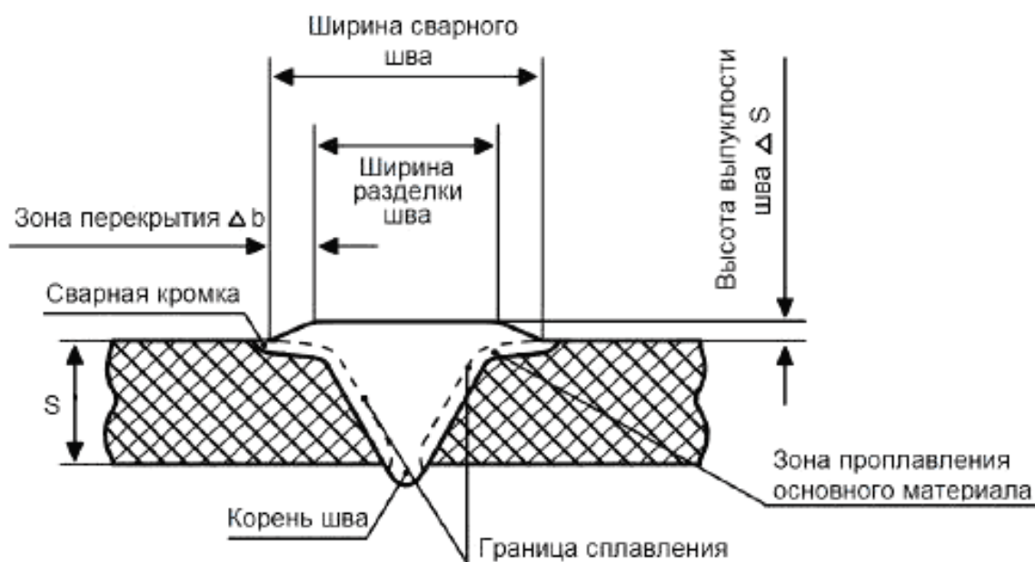
Рисунок 9 — Пример V-образного шва (показана зона проплавления основного материала, граница сплавления и зона перекрытия)
